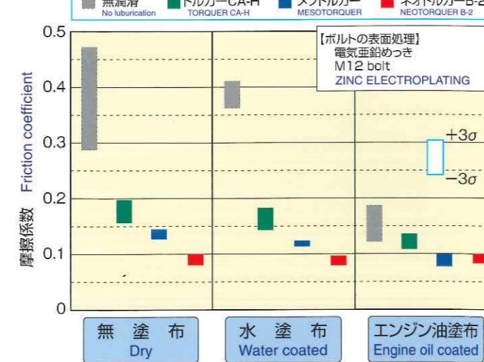
※このグラフはベンチテストによるデータであり、実際には相手の表面処理などによって摩擦係数が異なる可能性があります。特に相手の表面処理が電着塗装の場合、トルカーカーCA-H、メソトルカーカーでは摩擦係数が高めにできる可能性があります。
